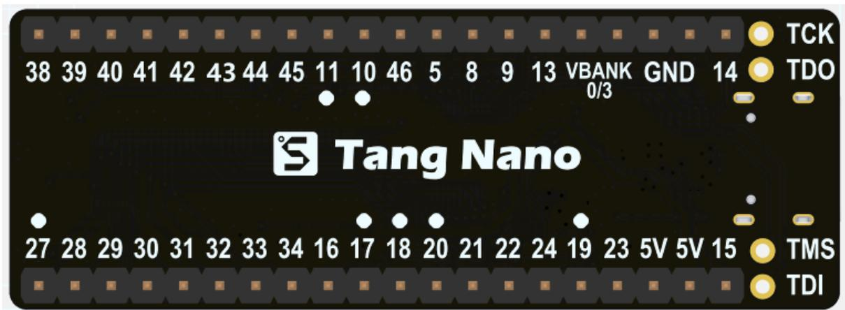
注：数字号码是芯片引脚号，圆点标识的引脚是 GCLK 引脚
